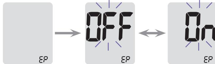
**참고:** 설정된 검사지 사용기한을 초과하면 검사지를 삽입하였을 때와 측정 후 측정결과가 화면에 표시될 때 EP가 표시됩니다. 예를 들어 검사지 사용기한을 2023년 10월로 설정했을 경우 2023년 11월이 되면 화면에 EP가 표시됩니다.
